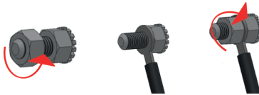
Rysunek 4. Podłączenie urządzenia do instalacji wyrównującej potencjały elektryczne.
